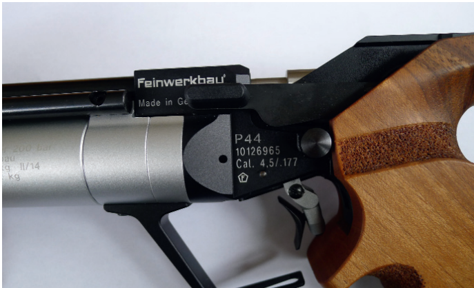
En liten stilstudie av avtrekkeren, ladearmen og sikringen som er den knappen som stikker ut under ladearmen.
