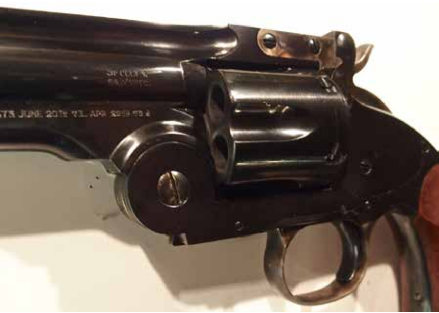
Detaljebilde av tønna og hengselbolt. Over tønns bakkant sees låsekaffen, som når denne bendes bakover, åpner revolveren
