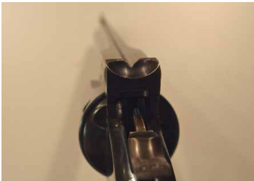
Nærbilde av baksiktet slik det fortøner seg for skytteren.
