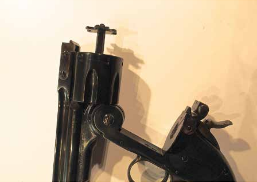
Revolveren i åpent tilstand. Her ser vi tydelig ekstraktoren som fjerner de tomme hylsene etter at de er avfyrt.
