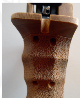
Hullene for justering av skjeftet. Det er to til på baksiden, altså 6 justeringsskruer, til sammen 8.
