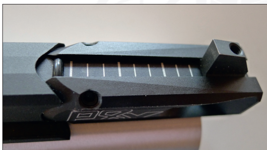
Kornet. Hullet på toppen er der du løsner det, hvis du vil forskyve det i lengderetningen.
