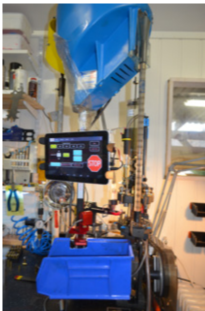
Disse fotoene illustrerer bruk av lademaskinen Dillon RL 1050 med motor slik det er beskrevet i teksten.
