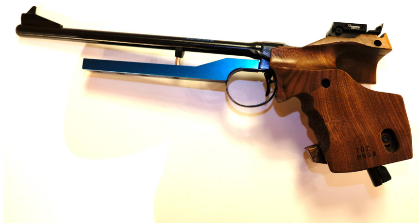
Samme pistol, men påmontert et nytt skjefte fra Rink Formgriffe. Forskjeftet i tre er erstattet av et i aluminium. Under skjeftet sees hendelen som åpner og lukker mekanismen.
