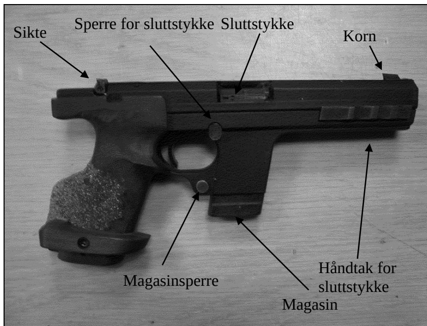
Automatpistol Hämmarli 280 kaliber.22 lr. En lett pistol grunnet bruk av plastmateriale.
