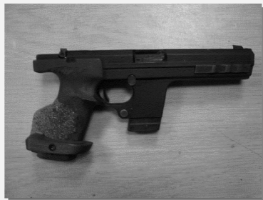
Automatpistol Hämmerli 280 kaliber.22 lr. En lett pistol grunnet bruk av plastmateriale.
