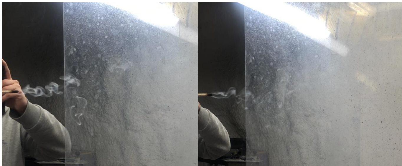
Figur 59: Bilde av røyken som føres i retning av luftstrømmen (innenfor plexiglass)
