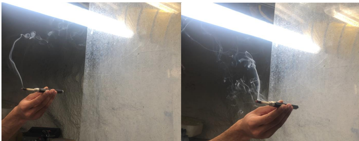
Figur 61: Bilde av Røyken beveges i motsatt retning av luftstrømmen (bak plexiglasset)
