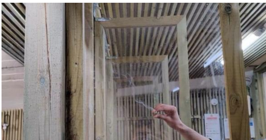
Figur 62: Bilde av røyken som beveges med luftstrømmen
